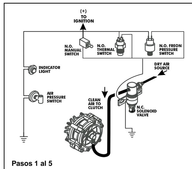
6. Conecte la punta roja (12 volts) ó la verde (24 volts) de la válvula solenoide a una terminal del interruptor térmico.
